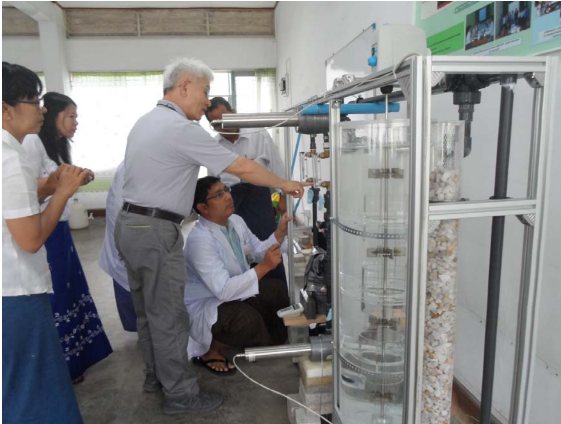
ပုံ-(၅)။ IAEA မှ ကျွမ်းကျင်သူ လာရောက်စဉ် Chemical Reactor ပိုက်လိုင်းအတွင်း အရည်စီးဆင်းမှုနှုန်းနှင့် ယိုစိမ့်မှုများအား radiotracer အသုံးပြု၍ လက်တွေ့တိုင်း တာလေ့လာမှုများ ပြုလုပ်စဉ်။
